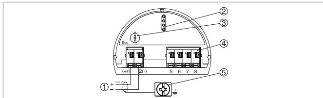
Отsek электроники и подключения (однокамерный корпус)
